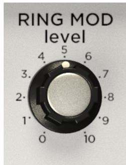
**Level:** Legt den Ausgangspegel des Ring Mod-Moduls fest.
