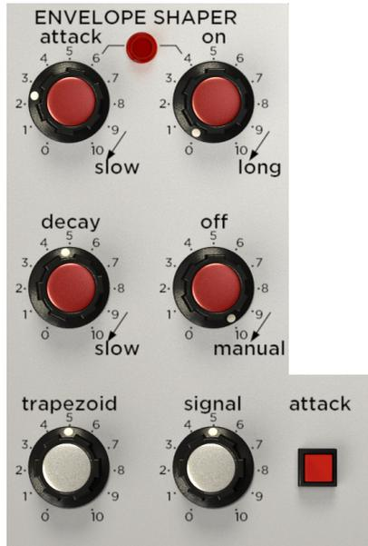
**Attack:** Dieser Regler stellt die Startverlaufszeit ("Attack") der ausgelösten Hüllkurve ein. "0" ist praktisch augenblicklich, während langsame (slow) Einstellungen mehr als eine Sekunde benötigen, um den maximalen Ausgangspegel zu erreichen.
