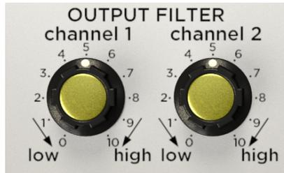
Dieses Ausgangsfiltermodul bietet zwei Filter, die Tiefpass- und Hochpassfilterung in einem einzigen Regler kombinieren. Auf diese Weise können Sie das Signal abschließend "veredeln", bevor es den Synthi verlässt.
