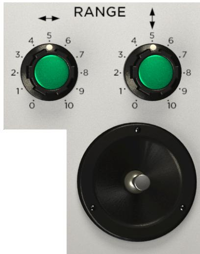
**Range-Regler (X- und Y-Achse):** Diese Regler skalieren die X- und Y-Ausgänge des Joysticks. Sie können sich diese Regler als Lautstärkereglern für die Joystick-Ausgänge vorstellen. Wenn ein Regler auf den maximalen Wert "10" eingestellt ist, gibt der Joystick seine Steuersignale mit voller Intensität aus und ein Empfangsmodul reagiert stark auf das Signal. Wenn der Joystickeinsatz weniger ausgeprägt sein soll, drehen Sie einen (oder beide) dieser Regler nach links.
