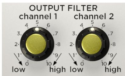
El módulo de filtro de salida incluye dos filtros que combinan el filtrado pasa bajos y pasa altos en un solo botón. Esto te permite hacer un sonido final "endulzado" a tu señal antes de que abandone el Synthi.
