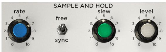
**Velocidad:** Establece la frecuencia de muestreo del módulo. La configuración de esta perilla se puede sincronizar con el tempo de tu DAW a través del interruptor de sincronización.
