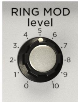
**Nivel:** Establece el nivel de salida del módulo Mod. en anillo.
