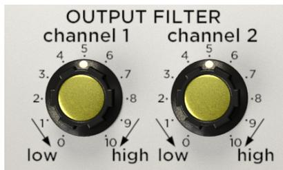
Le module Output Filter contient deux filtres combinant un filtrage passe-haut et passe-bas dans un seul potentiomètre. Il vous permet d'« adoucir » le son de votre signal avant qu'il ne quitte le Synthi.
