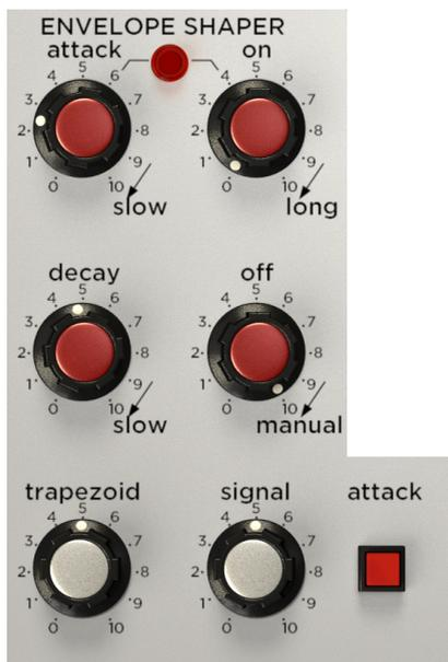
**Attack** : Ce potentiomètre détermine le temps de réaction (« attaque ») de l'enveloppe déclenchée. La valeur de « 0 » sera presque instantanée alors qu'il faudra plus d'une seconde pour atteindre les niveaux de sortie maximum à des réglages lents.
