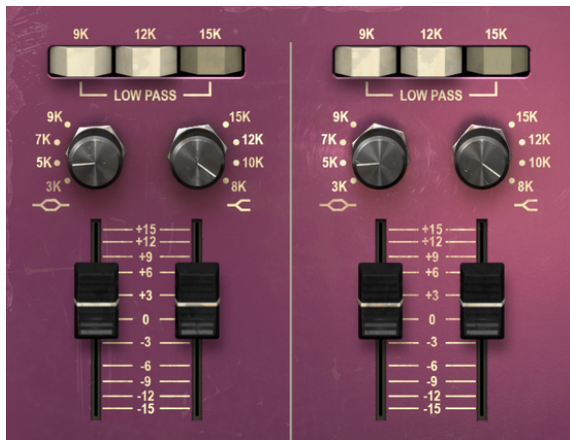
Die oberen Bänder des Pre TridA Double Channel EQ (High Shelf und High Midrange Bell) und die drei Low Pass Filter-Schalter oben
