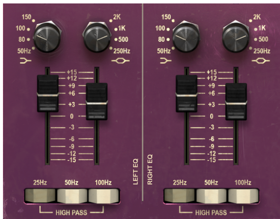
Die unteren Bänder des Pre TridA Double Channel EQ (Low Shelf und Low Midrange Bell) und die drei High Pass Filter-Schalter unten
