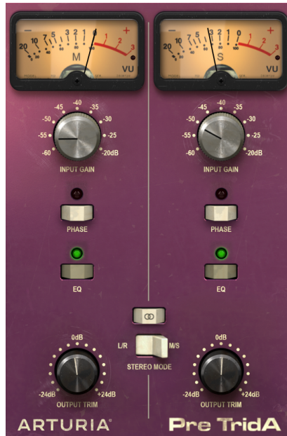
Der Pre TridA Preamp-Bereich im M/S-Modus. Beachten Sie, dass der Stereo Link-Schalter auf Off und der Stereo Mode-Schalter auf M/S steht.
