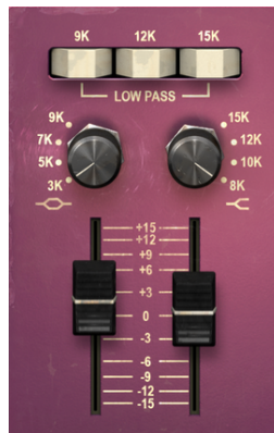
Der Pre TridA Single Channel EQ mit den oberen Bändern (High Shelf/High Mid Range Bell) sowie den drei Low-Pass-Filter-Schaltern
