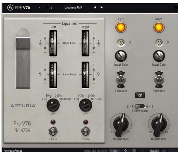
*Pre V76 configuré pour ajouter de l'« intensité » au son. Le Filtre passe-haut est aussi commuté pour couper les fréquences en dessous de 80 Hz*
