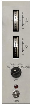
Pre V76の シングルチ ャンネル EQバンド とハイパス フィルター
