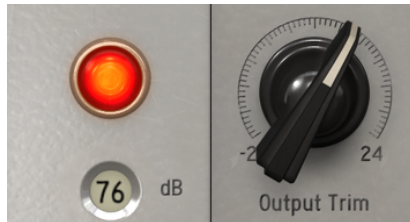
シングルチャンネルのグローランプ (アナログクリッピング時) と出力トリムノブ
