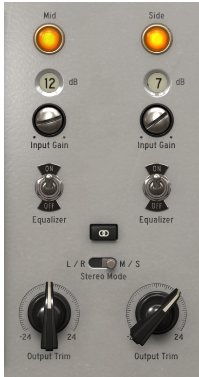
Pre V76ダブルチャンネルのプリアンプと出力。 ステレオリンクとステレオモードのスイッチは、出力トリムコントロールのすぐ上にあります。
