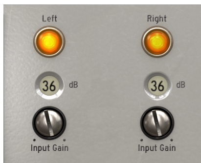
Der V76-Pre Double Channel mit Leuchtanzeige und dem Input Gain- Vorverstärker-Regler
