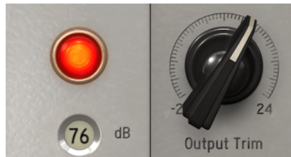
Die Single Channel Leuchtanzeige (beim Erreichen des analogen Clipping) und der Output Trim-Regler
