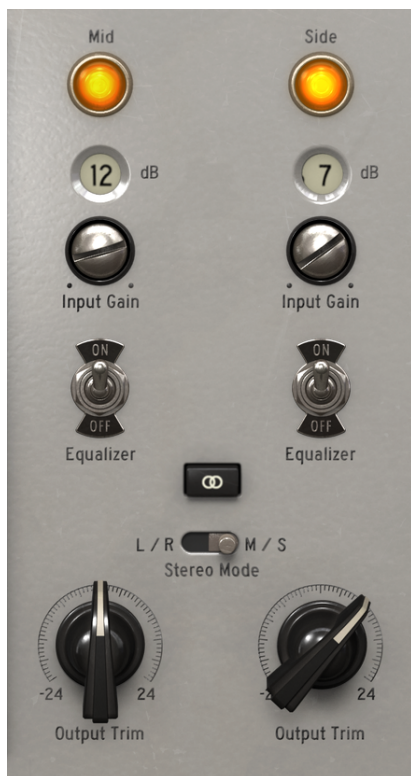
Der V76-Pre Double Channel Vorverstärker und Ausgang. Beachten Sie die Schalter Stereo Link und Stereo Mode direkt über den Output Trim-Reglern und den Leuchtanzeigen.
