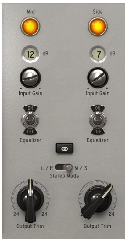
*Le préampli et la sortie de la configuration Double Channel de V76-Pre. Remarquez les interrupteurs Stereo Link et Stereo Mode, juste au-dessus des contrôles Output Trim, et les témoins lumineux de sortie en haut*
