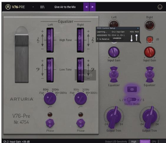
*V76-Pre en « apprentissage » MIDI. Remarquez la fenêtre de configuration du contrôle MIDI sur le contrôle sélectionné, qui est déjà assigné (lorsqu'il est assigné, la couleur devient rouge).*
