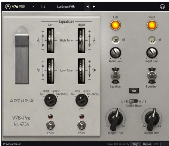
*V76-Pre configuré pour ajouter de l'« intensité » au son. Le Filtre passe-haut est aussi commuté pour couper les fréquences en dessous de 80 Hz*
