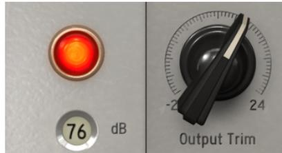
*Témoin lumineux de sortie de la configuration Single Channel (atteignant la saturation analogique) et potentiomètre Output Trim*
