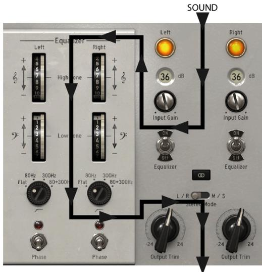
Après cela, le signal entre dans la partie égaliseur, où il sera transformé davantage en augmentant ou en supprimant les hautes et basses fréquences. Puisque les deux bandes sont fixes, nous disposons simplement d'un contrôle pour augmenter ou supprimer les hautes et basses fréquences.
