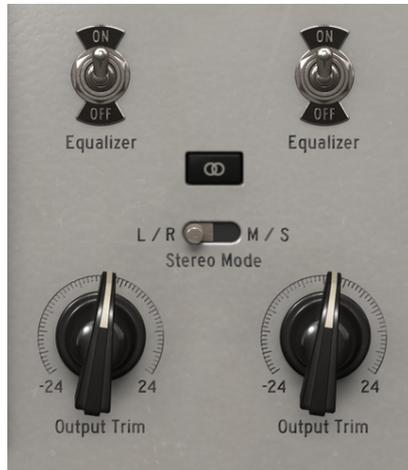
Nous disposons aussi d'interrupteurs de contrôles globaux qui affectent globalement le comportement du plug-in. Nous les avons déjà mentionnés : l'interrupteur On/Off de l'Equalizer, l'interrupteur Phase (qui inverse la phase du signal lorsqu'il est allumé) et, probablement les plus importants, les interrupteurs Stereo Link et Stereo Mode.
