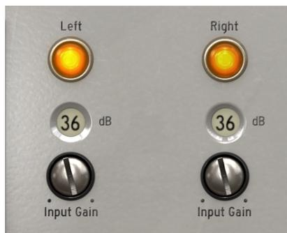
*Les contrôles de gain du Préampli et les témoins lumineux de sortie de la configuration Double Channel de V76-Pre*
